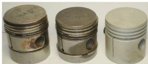
Drei Kolbengenerationen: Links der **Nüral-Kolben (Nürnberger Aluminiumwerke)**, in der Mitte einer von **SK (Kolben Schmitt)** und rechts der heute angebotene Kolben von **Finimpianti** aus Italien. Die Kolben aus den 60ziger Jahren hatten oben drei Kompressionsringe und der Nüral-Kolben zwei
